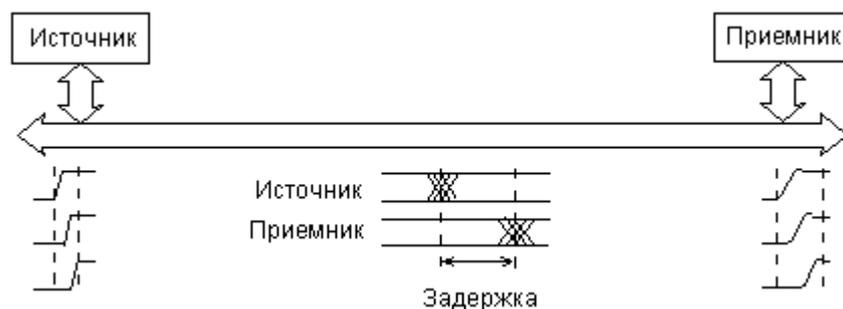
Рис. 2.14. Распространение сигналов во внешних шинах МП.
