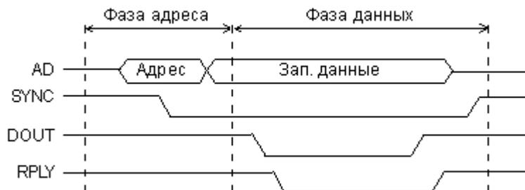
Рис. 2.5. Цикл записи на Q-bus
