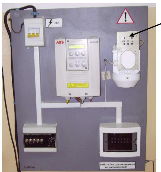
Рис. 1. Размещение датчика скорости/угла поворота
