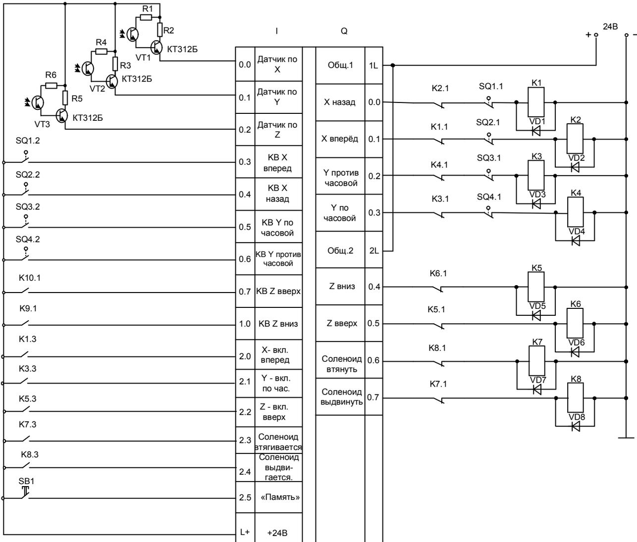
Рис. 7. Рекомендуемая схема подключения робота манипулятора к станку
