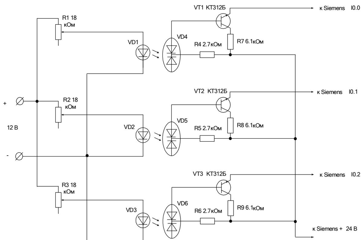
Рис. 6. Схема системы измерения положения рабочего органа
