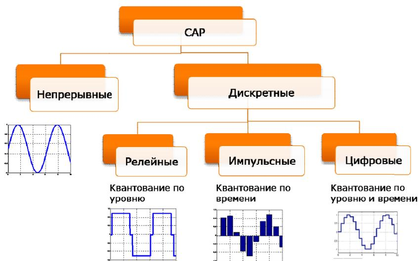
Рис.1.1. Классификация систем автоматического регулирования.
